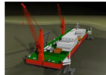
Баржа для рытья траншеи под трубопровод
